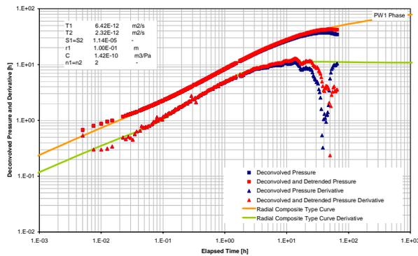
Figure 3. Diagnostic welltest analysis of PW1.
